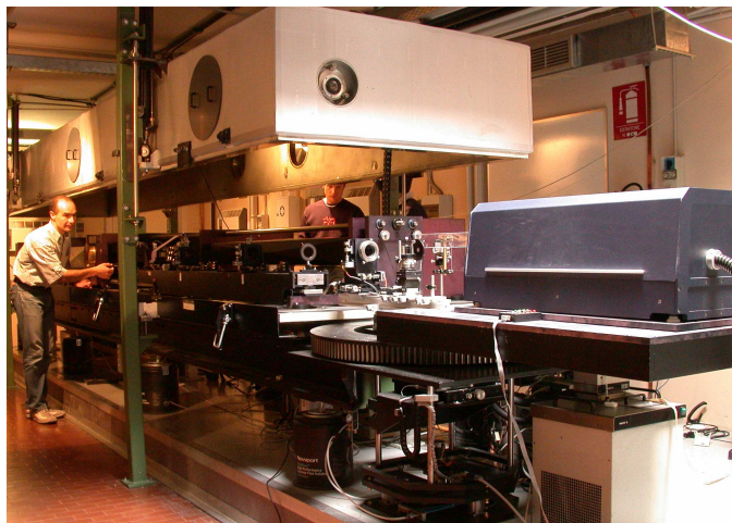
Spettrometro HIRESUUV per spettroscopia di Brillouin nel visibile e UV interamente progettato e realizzato presso il Dipartimento di Fisica dell'Aquila
